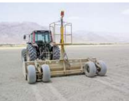
یک واحد تسطیح لولر لیزری مدل رینولدز ساخت کشور امریکا
